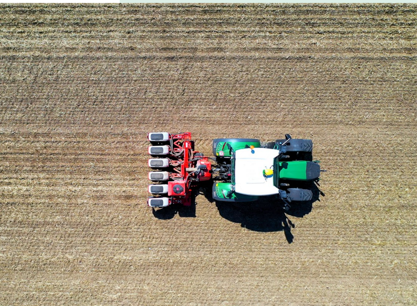
Durch den Einsatz eines Strip-Tillers können holzige Rückstände zwischen die Reihen gebracht werden, wo die Bodenstruktur intakt bleibt. Le passage avec un strip-tiller permet de décaler les résidus ligneux du rang et de les concentrer entre les rangs où la structure du sol est laissée intacte.
